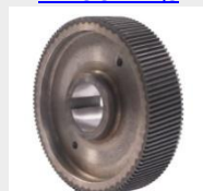
Зубчатое колесо м-4 Z-118 ОГМ-1,5
