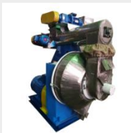
Гранулятор ОГМ-1,5-90 кВт/ч.
