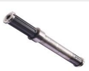
Вал шлицевой под усиленный подшипник 120х806 ОГМ-1,5 глухой
